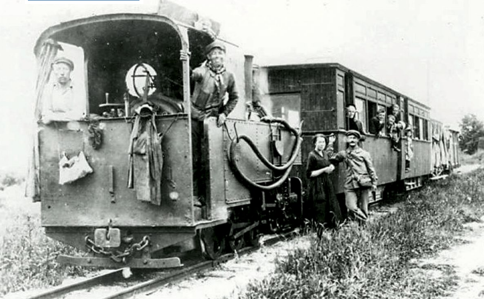
Un train de voyageurs dans la vallée de l'Ailette, sans doute à Crandelain. Les voitures ont été construites sur des wagons militaires : français « modèle 1888 » pour les caisses fermées et anglais « Clayton » pour les baladeuses ouvertes. Un fourgon, sans doute d'origine américaine, complète la composition. La Vie du Rail droits réservés.
