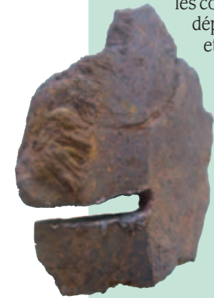
Eclat d'obus entaillé par le banc de scie en scierie
